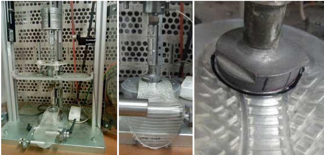
Figura 1.- Máquina de ensayos de amortiguación de impactos LecCus/IBV (ver Anexo I).
