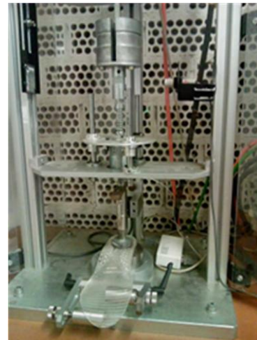
Figura 5.- Máquina de ensayos LecCus para el estudio de la amortiguación frente a cargas de impacto.
